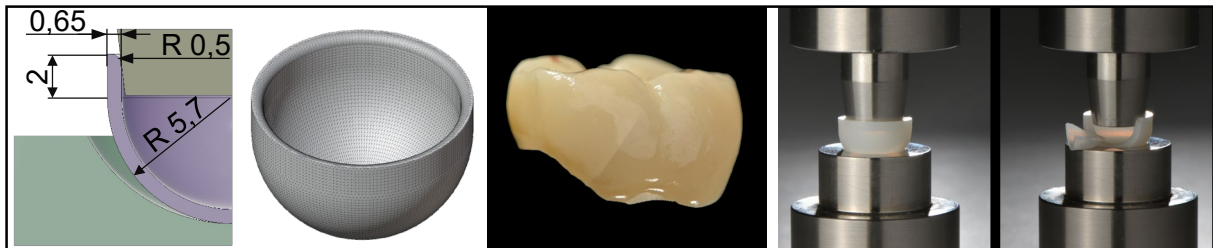
Bild 1: Modellierte Ersatzgeometrie (links) für eine Zahnkrone (Mitte) und Stempel-Druck-Versuch (rechts).
