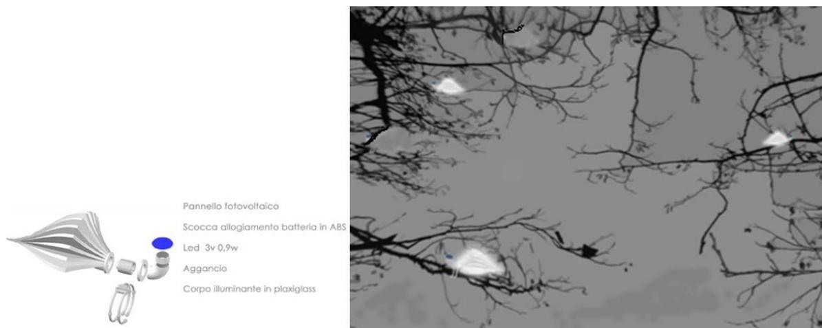
**Figure 3. The mini LED device**
