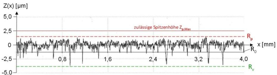
Abbildung 1: Rauheitsprofil einer aerostatischen Führungsfläche aus Naturhartgestein
