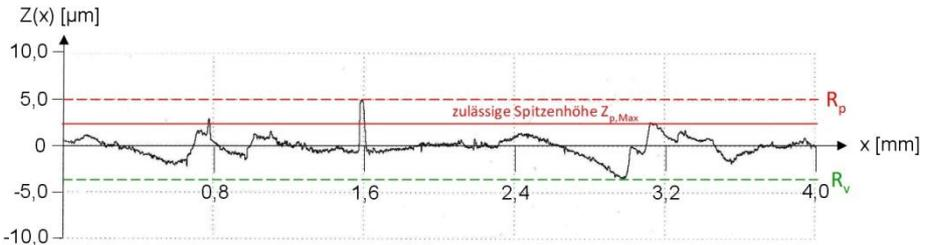
Abbildung 8: Oberflächenprofil der Messstrecke  $l_n=5,6$  mm mit  $R_a=0,51$   $\mu\text{m}$  und  $R_z=3,4$   $\mu\text{m}$  der abgeformten SVB-Oberfläche auf Naturhartgestein
