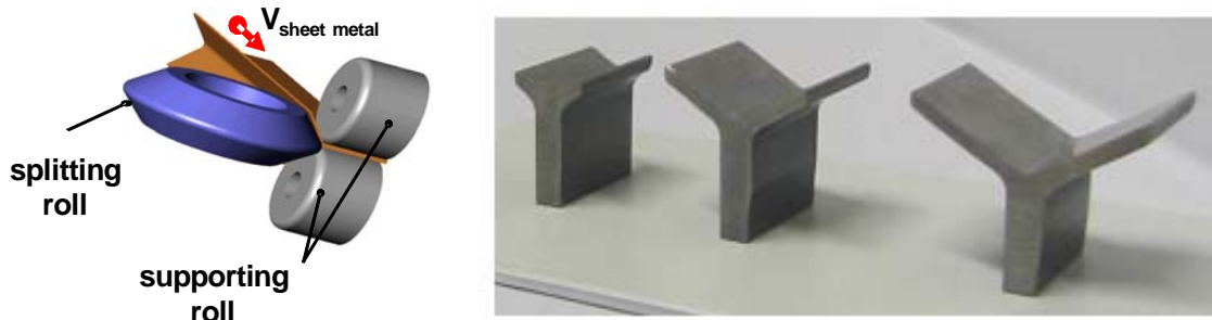
Bild 1: Verfahrensprinzip des Spaltprofilierens und Musterteile [13]
