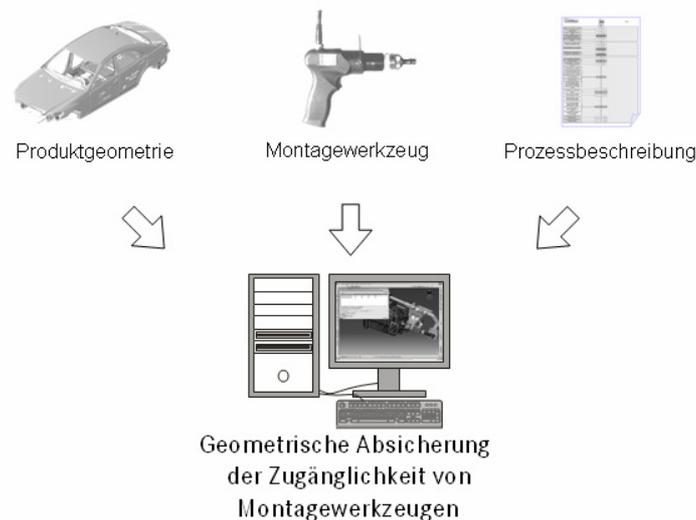
Bild 2: Eingangsgrößen bei einer Zugänglichkeitsuntersuchung von Montagewerkzeugen [7]
